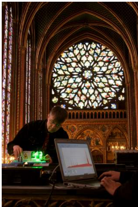
FIG. VII.19. Mesure à l'aide d'un spectromètre Raman portable de la nature des verres (silicates mixtes de potassium, calcium et sodium) constitutifs des vitraux (XIII e siècle) de la verrière de la Sainte-Chapelle (Paris). Source : Archives ouvertes de la société française d'optique. https://hal-sfo.ccsd.cnrs.fr/
