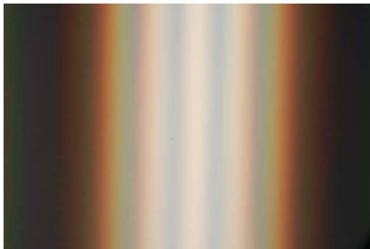
FIG. VII.15. Expérience des fentes d'Young en lumière blanche, visualisation des irisations. Source : archives ouvertes de la société française d'optique, #sfo-00291698, https://hal-sfo.ccsd.cnrs.fr/
