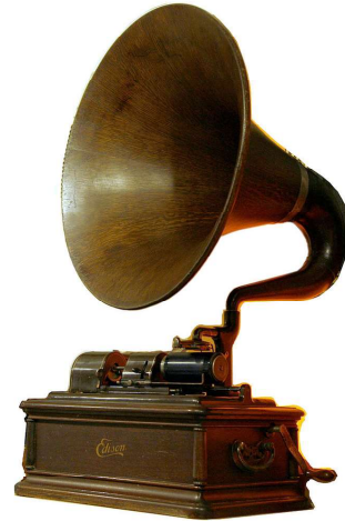
FIG. V.3. Pavillon acoustique (Musée Baud, Suisse) permettant de propager au mieux la transmission du son, par adaptation progressive d'impédance. Source : https://commons.wikimedia.org/wiki/File:Baud_museum_mg_8568.jpg .
